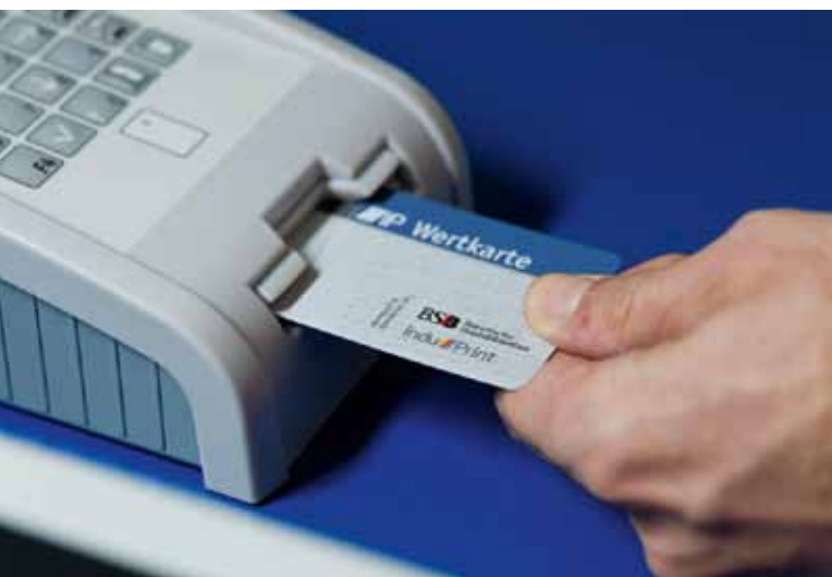
Teil der Follow-Print-Lösung: Das Wertkartenabrechnungssystem, das auch zur Identifizierung der Benutzerdruckjobs zum Einsatz kommt
